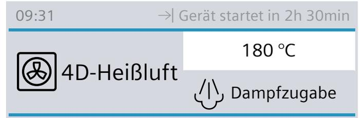
Der Backofen ist in Warteposition. In der Statuszeile erscheint das Symbol →I und die Zeit, wann der Betrieb fertig ist. Der Betrieb startet zum richtigen Zeitpunkt. Die Dauer läuft sichtbar in der Statuszeile ab.
