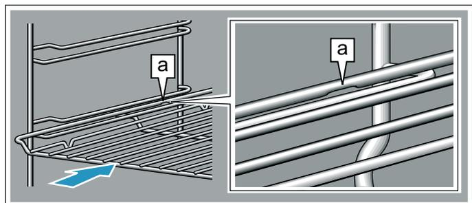
Achten Sie beim Einschieben von Blechen darauf, dass die Kerbe **a** hinten ist und nach unten zeigt. Die Abschrägung des Zubehörs **b** muss vorne zur Gerätetür zeigen.
