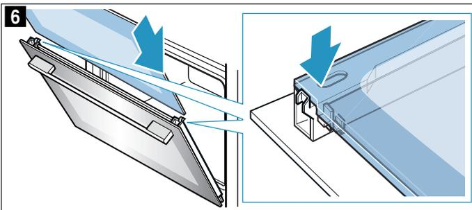
7. Abdeckung aufsetzen und andrücken bis sie hörbar einrastet (Bild 7).
