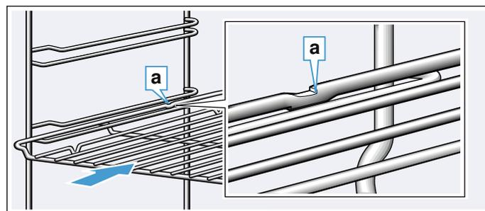
При установке противней следите за тем, чтобы прорезь **a** находилась сзади и была обращена вниз. Скошенный край противня **b** должен быть обращён вперёд к дверце прибора.
