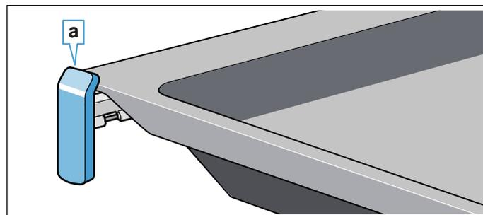
Выдвигающие направляющие фиксируются при полном выдвигании. Это облегчает установку принадлежностей в прибор. Для расфиксирования необходимо слегка нажать на выдвигающие направляющие при задвигании их обратно в рабочую камеру.
