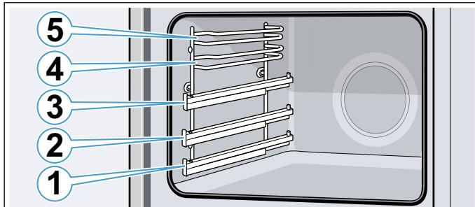
In den Einschubhöhen 4 und 5 das Zubehör immer zwischen die beiden Führungsstäbe einer Einschuhhöhe schieben.
