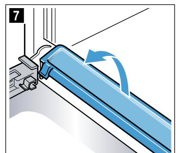
Reinigen Sie die Scheiben mit Glasreiniger und einem weichen Tuch. Wischen Sie die Kondensatleiste mit einem Tuch und heißer Spülflüssigkeit ab.
