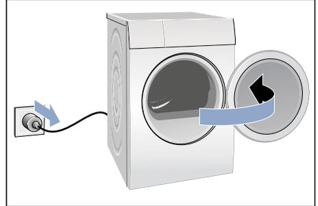
2. Entfernen Sie die Schrauben am Trockner und nehmen Sie die Trocknertür anschließend ab.
