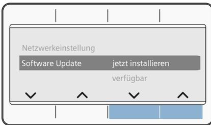
**Hinweis:** Das Aktualisieren der Software kann mehrere Minuten dauern. Schalten Sie das Gerät während der Aktualisierung nicht aus.
