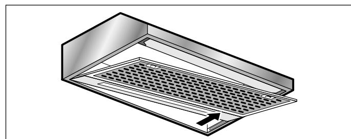
4. Retirer les fils et le mat filtrant.
