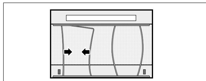
5. Nettoyer l'intérieur de l'appareil après avoir démonté le filtre à graisse métallique.
