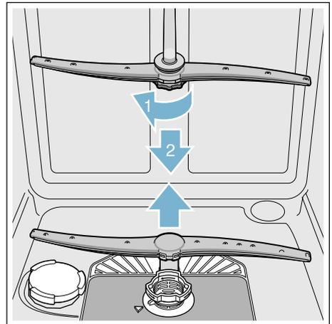
4. Sprüharme unter fließendem Wasser reinigen.
