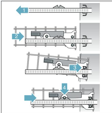
**Retirer / installer le panier à vaisselle inférieur**
