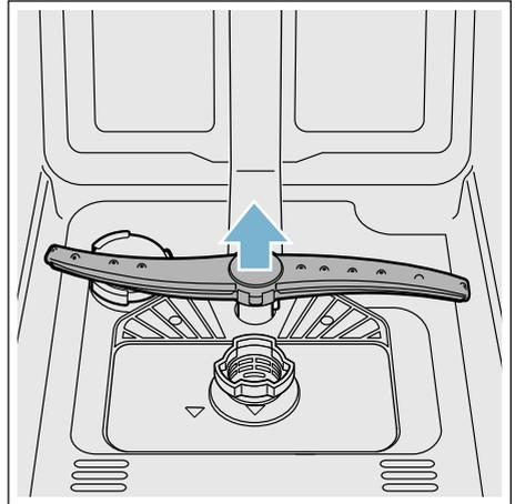
4. Sprüharme unter fließendem Wasser reinigen.
