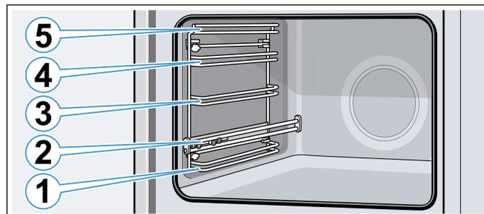
Ai livelli di inserimento 1, 3, 4 e 5, inserire l'accessorio sempre tra entrambe le aste guida di un livello di inserimento.
