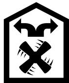
Втягнуте витяжкою повітря очищається, проходячи через жиропоглинаючий та вугільний фільтр, і повертається потім до кухні.
