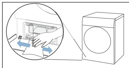
4. Lossa spaken till värmeväxlarskyddet.
