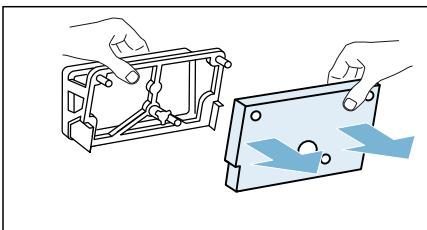
**Anvisning:** Se till så att du inte skadar filtermattan.
