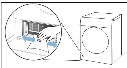
**Anvisning:** Se till så att du inte skadar den frilagda värmeväxlaren.
