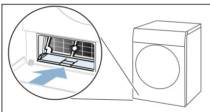
11. Skjut in värmeväxlarskyddet med handtaget.
