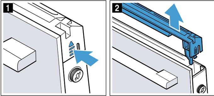
**Hinweis:** Den Edelstahlbleger in der Abdeckung mit Edelstahlreiniger reinigen. Die restliche Türabdeckung mit Spüllauge und einem weichen Tuch reinigen.
