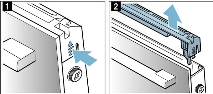
**Norādījums:** Notīriet pārsega nerūsējošā tērauda ieliktni ar nerūsējošā tērauda tīrīšanas līdzekli. Pašu durvju pārsegu notīriet ar ūdeni, kam pievienots nedaudz mazgāšanas līdzekļa, un mīkstu drānu.
