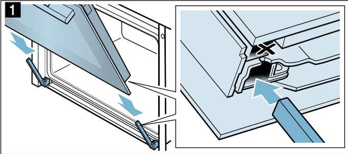
2. Pilnībā atveriet ierīces durvis. Vēlreiz nostipriniet abas fiksēšanas sviras (**2** attēls).
