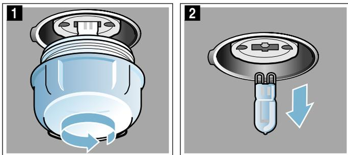
4. Ieskrūvējiet stikla pārsegu. Atkarībā no ierīces tipa stikla pārsegs ir aprīkots ar blīvgredzenu. Pirms ieskrūvēšanas uzlieciet blīvgredzenu atpakaļ.
