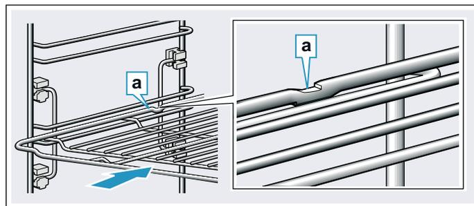
При установке противней следите за тем, чтобы прорез **a** находился сзади и была обращена вниз. Скошенный край противня **b** должен быть обращён вперёд к дверце прибора.
