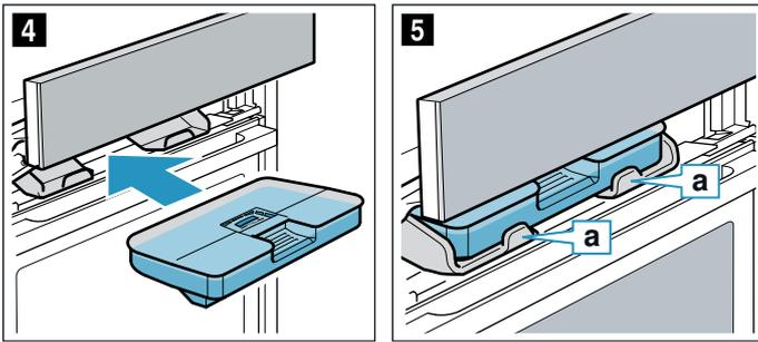
7. Медленно передвиньте панель вниз, затем отожмите её назад, пока она полностью не закроется. Резервуар наполнен. Теперь можно запустить режим с использованием пара.
