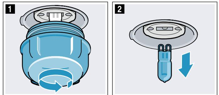
4. Avvitare nuovamente la copertura in vetro. A seconda del tipo di apparecchio, la copertura in vetro è dotata di anello di tenuta. Applicare nuovamente l'anello di tenuta prima di avvitare.
