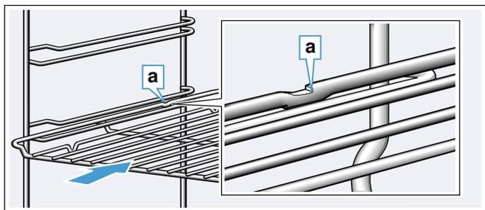
Al introducir las bandejas, asegurarse de que la ranura **a** se encuentra en la parte trasera y señala hacia abajo. El desnivel de los accesorios **b** debe señalar por delante hacia la puerta del aparato.
