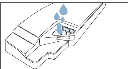
**提示：**始终水平握住装满水的冷凝水盒，以防液体溢出。
