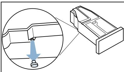
11. 将过滤器装入冷凝水盒上的凹口中。
