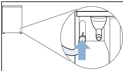
5. 将排水软管从附件中取出，固定到闲置的出水口上，将其向上推到止档处。
