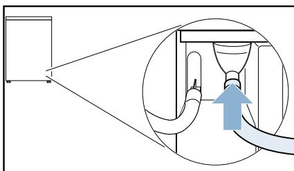
6. 根据连接状况，使用剩余附件固定排水软管的另一端。
