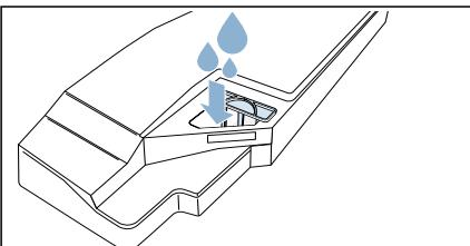
**提示：** 始终水平握住装满水的冷凝水盒，以防液体溢出。
