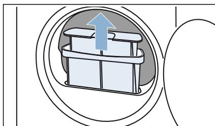
3. 清除绒毛收集器安装槽处的绒毛。请确保没有绒毛落入开放的绒毛收集器安装槽中。
