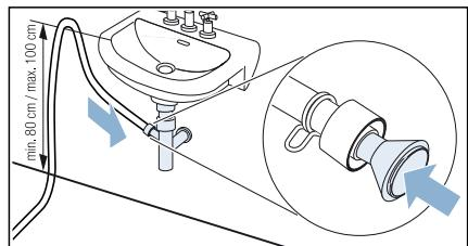
连接点必须使用软管卡箍固定（夹持范围：12-22 mm，可在专卖店购买）。当连接到虹吸管时，请确保排水软管的敷设高度至少为 80 cm，但不超过 100 cm。
