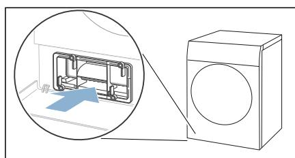
**提示：**您只可在插片已在电器的内部时将热能交换器盖板滑入。
