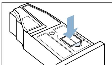
9. 将冷凝水盒再次转动 180°，将塞子插入冷凝水盒顶部的凹口中。
