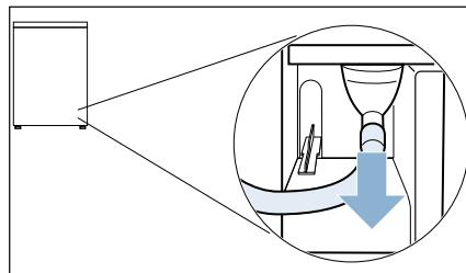
**提示：**交付电器时，冷凝软管已经装在排水口上。
