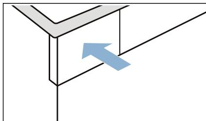
**提示：**冷凝水盒中的过滤器用于过滤电器自动清洁时所用的冷凝水。过滤器可通过倒空冷凝水进行清洁。您仍应定期检查过滤器是否有任何积聚，必要时将其清除。
