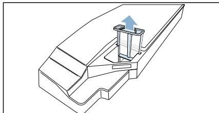
8. 将冷凝水盒转动 180°，使其掉头朝下，取出固定在此处的塞子。
