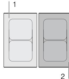
**Remarque :** Au niveau de la zone combinée, la fonction Powerboost peut uniquement être activée si les deux foyers sont utilisés indépendamment l'un de l'autre.
