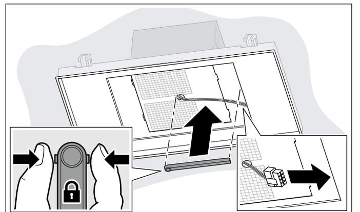
9. Kabelkanal seitlich zusammendrücken, aufsetzen und einrasten.
