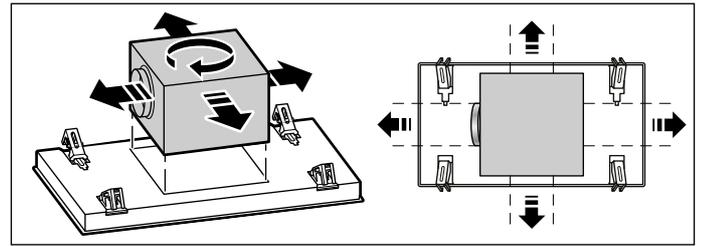
5. Lüfterkasten auf die Seite schieben und Stromanschluss herstellen.
