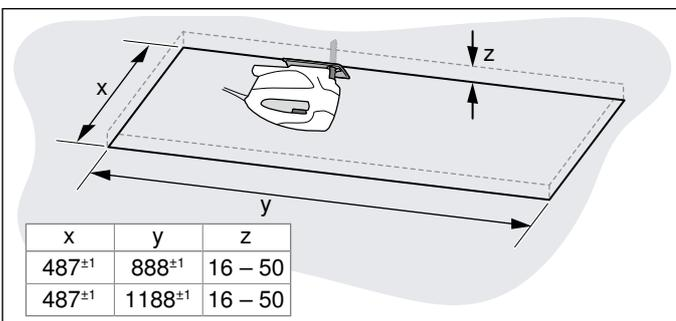
3. Nach Ausschnittarbeiten Späne entfernen.
