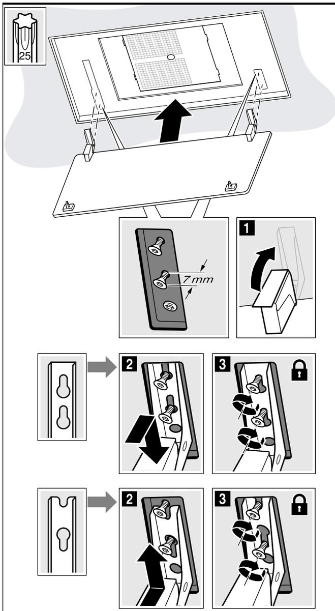
4. Metallfettfilter einsetzen.
