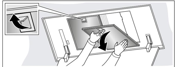
4. Metallfettfilter aus der Halterung herausnehmen.
