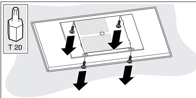
4. Lüfterkasten entsprechend der Einbausituation in die richtige Position drehen.
