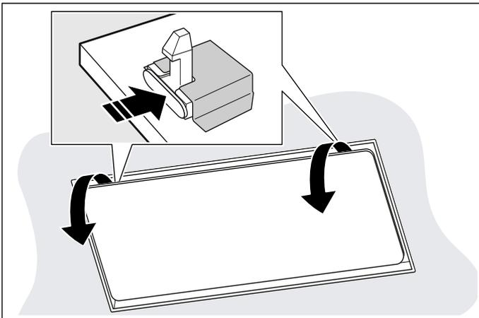
2. Filterabdeckung vollständig und ohne Zug öffnen. **Hinweis:** Filterabdeckung kann schwingen. Filterabdeckung immer langsam öffnen und schließen. Darauf achten, dass die Filterabdeckung nach dem Loslassen nicht nachschwingt.
