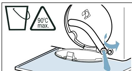
4. Svitare con cautela la copertura della pompa; è possibile la fuoriuscita di acqua residua.
