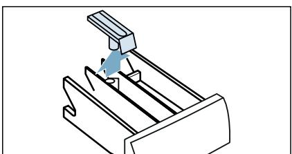
3. Pulire il vano dello scomparto detersivo e l'inserto con acqua e una spazzola e asciugare. Pulire anche l'interno della struttura.
