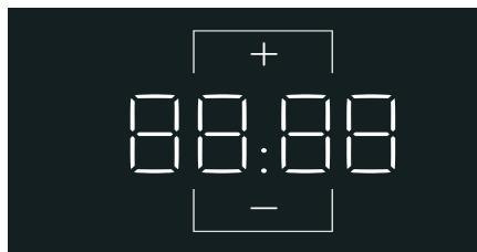
3. Selezionare il tasto **>III**. Il programma si avvia. Il numero di ore selezionato (ad es. **8h**) viene visualizzato sul pannello display e diminuisce fino all'avvio del programma. Viene quindi visualizzata la durata del programma.
