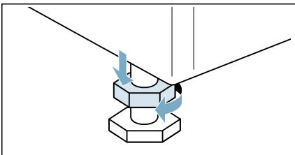
2. Verificare l'allineamento dell'apparecchio con una livella a bolla, regolarlo se necessario. Regolare l'altezza ruotando i piedini dell'apparecchio. Tutti e quattro i piedini dell'apparecchio devono poggiare saldamente al suolo.
