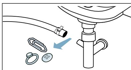
4. Ricollegare il tubo flessibile di scarico e assicurare il punto di collegamento tramite la fascetta del tubo flessibile.
