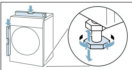
3. Avvitare saldamente il dado di bloccaggio contro la struttura della lavasciuga. Nel farlo, tenere saldamente il piedino e non regolarne l'altezza. I dadi di bloccaggio di tutti e quattro i piedini dell'apparecchio devono essere avvitati saldamente contro la struttura della lavatrice.
