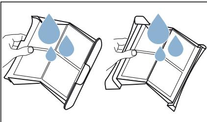
8. Séchez les filtres à peluches, remettez-les en place l'un dans l'autre.
