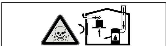
I focolari che dipendono dall'aria ambiente (peres. a gas, olio, legna o carbone, scaldabagno, caldaie elettriche) ricavano l'aria per la combustione dalla stanza ed eliminano i gas di scarico all'esterno attraverso un impianto (peres. camino). In concomitanza della cappa accesa, dalla cucina e dalle stanze adiacenti viene sottratta dell'aria: senza un'alimentazione sufficiente di aria si crea depressione. I gas velenosi dal camino o dalla cappa di aspirazione vengono riaspirati nelle stanze.
