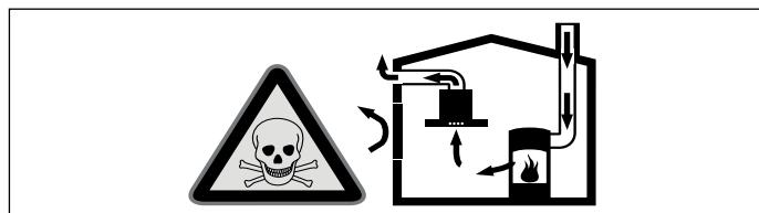
Raumlufthängige Feuerstätten (z.B. gas-, ölf-, holz- oder kohlebetriebene Heizgeräte, Durchlauferhitzer, Warmwasserbereiter) beziehen Verbrennungsluft aus dem Aufstellraum und führen die Abgase durch eine Abgasanlage (z.B. Kamin) ins Freie.
