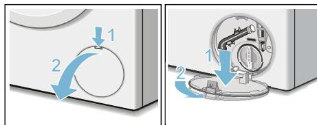
4. Sortez le flexible de vidange de sa fixation. Retirez la coiffe d'obturation, laissez le bain lessiviel s'écouler dans un récipient adéquat. Enfoncez la coiffe obturatrice et mettez le flexible de vidange en place dans la fixation.
