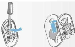
2. Mettre les 4 douilles en place. Fixer fermement le cordon d'alimentation électrique aux fixations. Mettre les vis des cales de transport en place et les serrer à l'aide d'une clé plate SW13.
