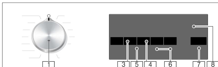
**1 Sélecteur de programme :** pour sélectionner un programme et pour allumer et éteindre le lave-linge par la position **Arrêt** (○) ; Vous trouverez un aperçu de tous les programmes dans le supplément à la notice d'utilisation et d'installation. **Modifier**
