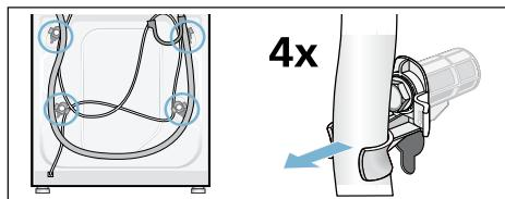
2. Dévisser les 4 cales de transport à l'aide d'une clé plate SW13 et les retirer.
