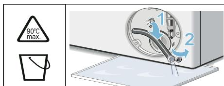
5. Dévissez délicatement le bouchon de la pompe, de l'eau résiduelle peut s'écouler. Nettoyez le compartiment intérieur, le filetage du couvercle de pompe et le carter de pompe. Le rotor de la pompe de vidange doit pouvoir tourner librement. Remettez le couvercle en place et vissez-le. Il faut que la poignée se trouve à la verticale.
