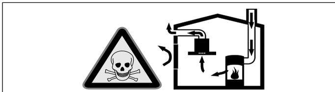
Raumluftabhängige Feuerstätten (z.B. gas-, öl-, holz- oder kohlebetriebene Heizgeräte, Durchlauferhitzer, Warmwasserbereiter) beziehen Verbrennungsluft aus dem Aufstellraum und führen die Abgase durch eine Abgasanlage (z.B. Kamin) ins Freie. In Verbindung mit einer eingeschalteten Dunstabzugshaube wird der Küche und den benachbarten Räumen Raumluft entzogen - ohne ausreichende Zuluft entsteht ein Unterdruck. Giftige Gase aus dem Kamin oder Abzugsschacht werden in die Wohnräume zurückgesaugt.
