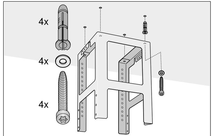
4. Vier Löcher mit  $\varnothing 8$  mm und Bohrtiefe 80 mm für die Befestigungen bohren und die Dübel bündig eindrücken
