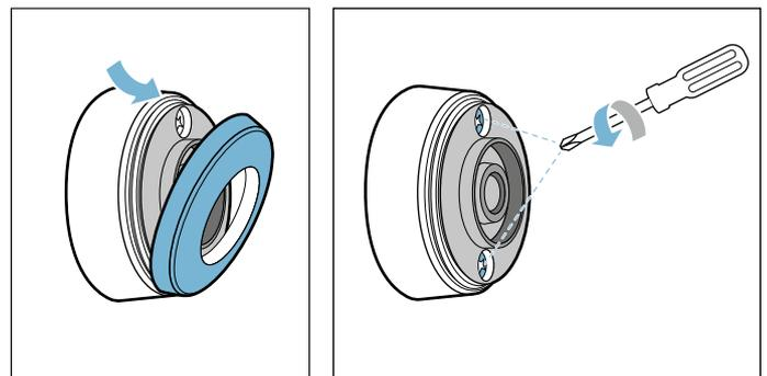
2. Den Verschluss des Kochsensors öffnen. Die Batterie aus dem Gehäuseunterteil herausnehmen und eine neue Batterie einsetzen (dabei auf die richtige Ausrichtung der Batteriepole achten).
