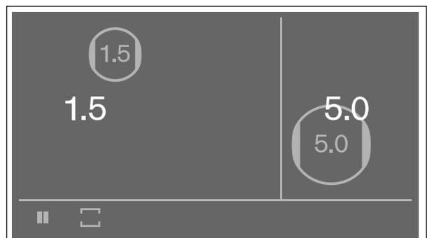
Um die kombinierten Bereiche wieder zu trennen, auf einen der vertikalen Ränder des Bereiches tippen und mit dem Finger nach rechts oder links streichen, bis der verborgene Bereich wieder angezeigt wird.
