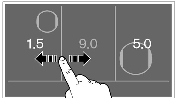
Die Leistungsstufe des kombinierten Bereichs ist die gleiche Stufe wie die des Bereichs, der erweitert wird.
