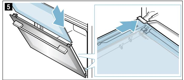
6. Presionar la parte superior del cristal exterior (figura 6).
