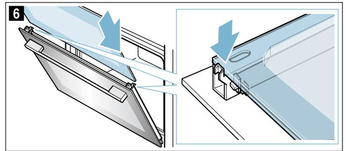
7. Colocar la cubierta y presionar hasta que se oiga que ha encajado (figura 7).
