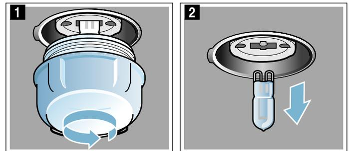
4. Volver a atornillar el cristal protector. En función del tipo de aparato, el cristal protector estará equipado con una junta tórica. Volver a encastrar la junta tórica antes de atornillar el cristal protector.
