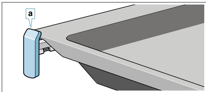
Los rieles de extracción se encajan cuando están totalmente extraídos. De esta manera, el accesorio puede colocarse fácilmente. Para desencajarlos, volver a introducir los rieles de extracción en el compartimento de cocción ejerciendo un poco de presión.
