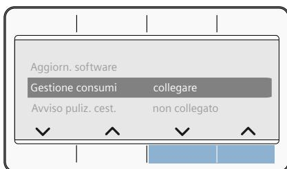
L'apparecchio tenta ora di collegarsi al sistema Smart Energy (gestore dei consumi). Una volta completato il collegamento dell'apparecchio, sul display compare: **collegato ✓**.
