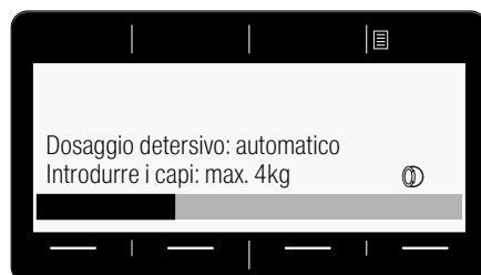
La barra di caricamento si riempie man mano che viene aggiunta la biancheria. Se si supera il carico massimo la barra diventa intermittente. Rispettare la quantità di carico massima indicata. Un carico eccessivo peggiora il risultato di lavaggio e favorisce la formazione di squalciture.
