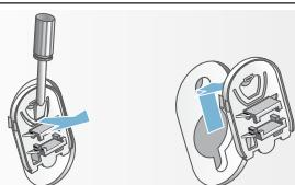
2. Inserire tutte le 4 boccole. Fissare il cavo di alimentazione nei fermi. Reinserire le viti dei blocchi per il trasporto e fissarle con una chiave inglese da 13.
