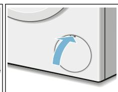
**Avvertenza:** Per impedire che al successivo lavaggio il detersivo si depositi utilizzato nel circuito di scarico, versare 1 litro di acqua nello scomparto e avviare il programma **Scarico acqua**.
