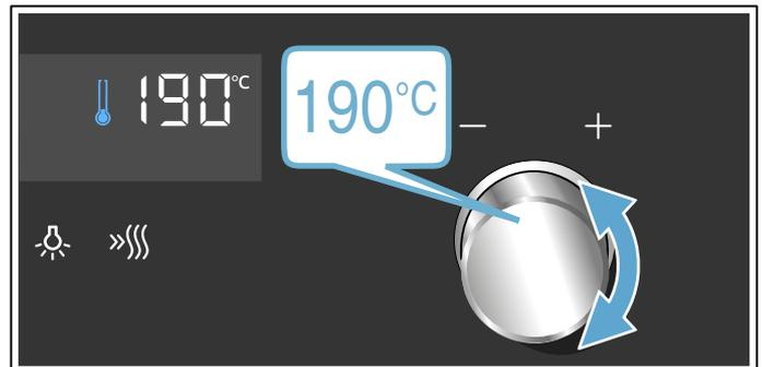
L'appareil commence à chauffer après quelques secondes.
