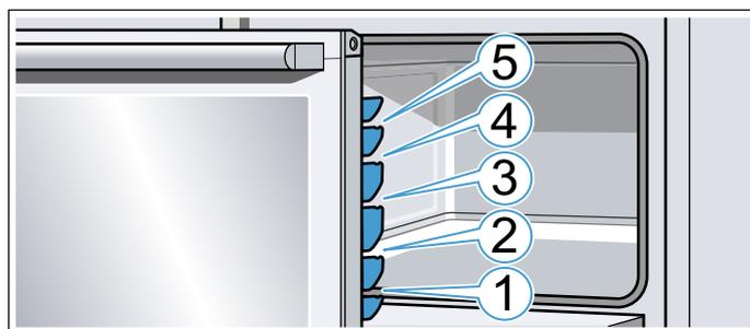
Insérez l'accessoire dans les crochets de droite et de gauche. En l'insérant, veillez à ce que l'accessoire soit fermement en place dans les crochets, sans quoi il pourrait tomber.
