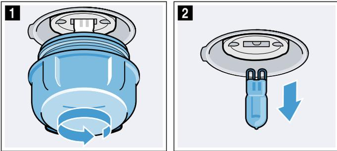
4. Révissez le cache en verre. Selon le type d'appareil, le cache en verre est équipé d'un anneau d'étanchéité. Remettez l'anneau d'étanchéité en place avant de visser.
