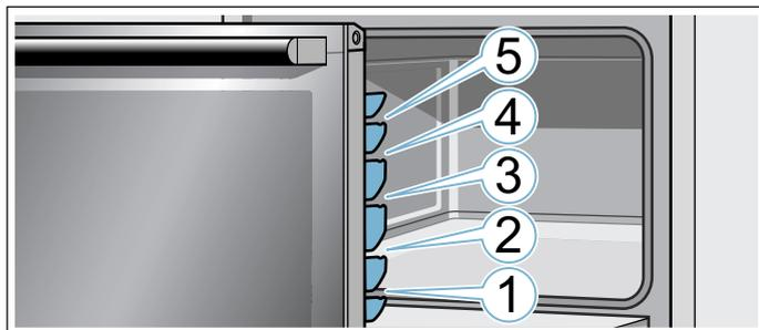
Insérez l'accessoire dans les crochets de droite et de gauche. En l'insérant, veillez à ce que l'accessoire soit fermement en place dans les crochets, sans quoi il pourrait tomber.
