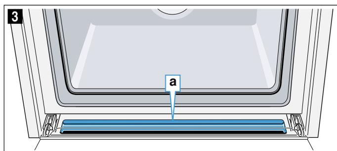
**Upozornění:** Pokud se těsnění uvolní, nasadte těsnění znovu na odkapávací žlábek. → "Dvířka spotřebiče" na straně 33
