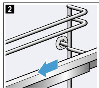
Καθαρίστε τις υποδοχές (οδηγούς) με υγρό καθαρισμού πιάτων και ένα μαλακό σφουγγάρι. Σε περίπτωση σκληρής ρύπανσης χρησιμοποιήστε μια βούρτσα.
