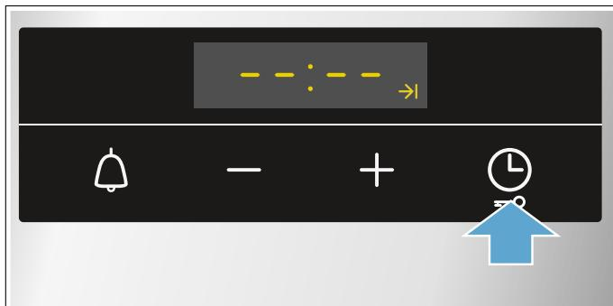
4. Ρυθμίστε με το πεδίο αισθητήρα – ή με το πεδίο αισθητήρα + το χρόνο λήξης.
