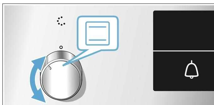
2. Με το διακόπτη επιλογής θερμοκρασίας ρυθμίστε τη θερμοκρασία ή τη βαθμίδα ψησίματος στο γκρίλ.
