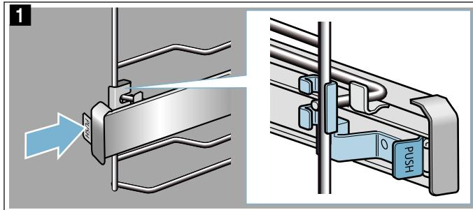
2. Mantenha "PUSH" pressionado e vire a calha para fora (figura 2).
