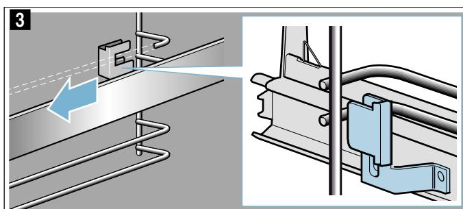
4. Remover a calha extensível (figura 4)
