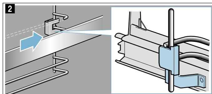
3. Pressione "PUSH" e vire a calha para dentro, de modo a que o suporte se encontre entre as duas barras (figura 3).
