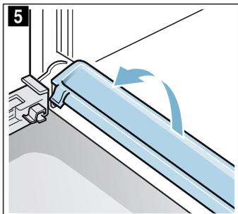
Limpe os vidros com um produto limpa-vidros e um pano macio. Limpe a régua de condensado com um pano e solução quente de água e detergente.
