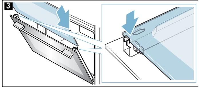
5. Colocar la cubierta y presionar hasta que se oiga que ha encajado (figura 4).
