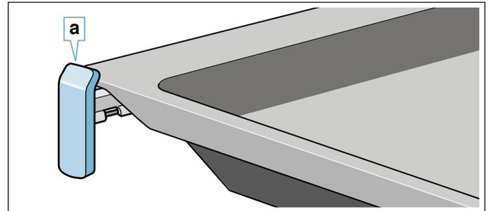
Los rieles de extracción se enclavan cuando están totalmente extraídos. De esta manera, el accesorio puede colocarse fácilmente. Para desenclavarlos, volver a introducir los rieles de extracción en el interior del aparato ejerciendo un poco de presión.
