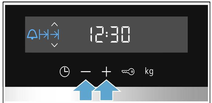
Tras unos segundos, el aparato aplica los ajustes. En el panel indicador se muestra la hora de finalización. En cuanto se pone en marcha el horno, se muestra el transcurso del tiempo.
