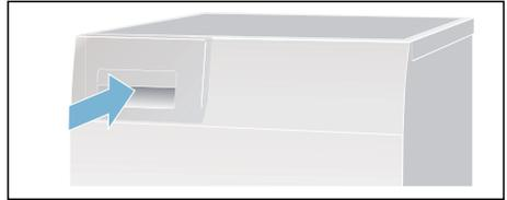
**Hinweis:** Das Sieb im Kondenswasser-Behälter filtert das Kondenswasser, das zur automatischen Reinigung Ihres Trockners verwendet wird. Das Sieb wird durch Entleeren des Kondenswassers gereinigt. Prüfen Sie das Sieb trotzdem regelmäßig auf verbliebene Ablagerungen und entfernen diese. Siehe → Seite 46.
