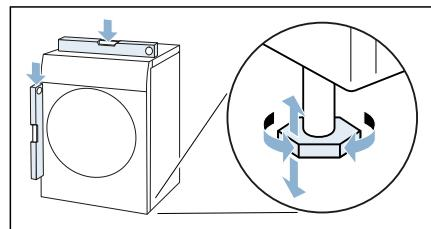
3. V případě potřeby spotřebič znova vyrovnejte otáčením nožiček.
