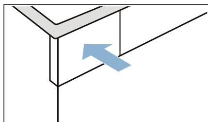
**Upozornění:** Sítko v nádržce na kondenzovanou vodu filtryuje kondenzovanou vodu, která se používá pro automatické čistění spotřebiče. Sítko se čistí vyprázdněním kondenzované vody. Přesto sítko pravidelně kontrolujte, zda v něm nejsou usazené nečistoty, a případně je odstraňte.
