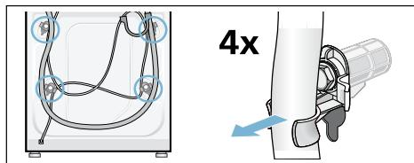
2. Alle 4 Transportsicherungs-schrauben mit einem Schraubenschlüssel SW13 lösen und entfernen. Hülsen entfernen. Dabei Netzleitung aus den Halterungen nehmen.
