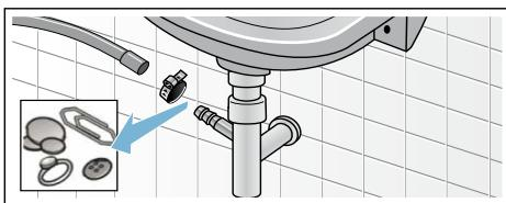
4. Ablaufschlauch wieder aufstecken und Anschluss-Stelle mit Schlauchschelle sichern.
