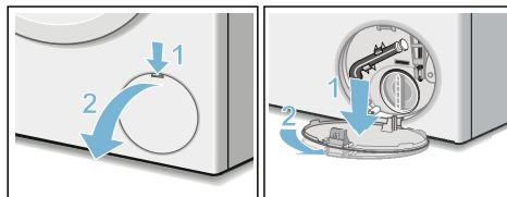
4. Entleerungsschlauch aus der Halterung nehmen. Verschlussklappe abziehen, Lauge in geeignetes Gefäß abfließen lassen. Verschlussklappe aufdrücken und Entleerungsschlauch in die Halterung einsetzen.
