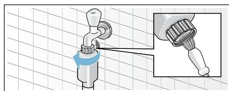
2. Bei Modellen Standard und Aqua-Secure Sieb an der Geräterückseite reinigen: Schlauch an der Geräterückseite abnehmen, Sieb mit Zange herausnehmen und reinigen.
