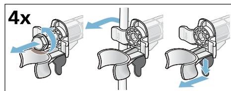
3. Mettre les couvercles en place. Verrouiller fermement les couvercles en appuyant sur le crochet de blocage.
