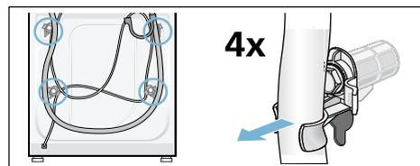
2. Dévisser les 4 cales de transport à l'aide d'une clé plate SW13 et les retirer. Enlever les douilles. Sortir le cordon d'alimentation de ses supports.
