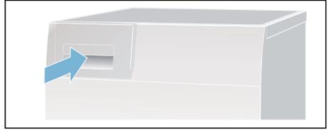
**Nota:** El filtro del recipiente de condensación filtra la condensación que se usa durante el ciclo de limpieza automática de la secadora. El filtro se limpia al vaciar la condensación. No obstante, se debe revisar el filtro a intervalos regulares por si hay depósitos y eliminarlos. Consultar → *Página 33.*
