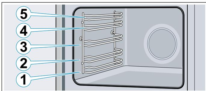
Introduire l'accessoire toujours entre les deux barres de guidage d'un niveau d'enfournement.
