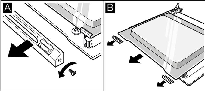
4. Halteklammern rechts und links aufschrauben. Scheibe anheben und Klammern von der Scheibe abnehmen (Bild C).
