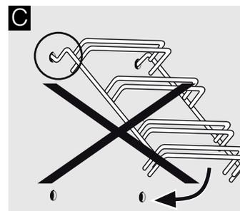
2. Beide Haken müssen vollständig in den oberen Löchern eingehängt sein. Jetzt das Gestell langsam und vorsichtig nach unten bewegen und in die unteren Löcher einhängen (Bild D).
