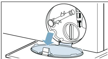
3. Retire a mangueira de escoamento do retentor. Remova a tampa de vedação e verta a água para um recipiente adequado. Substitua a tampa de vedação e recolque a mangueira de escoamento no retentor.
