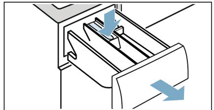
2. Para remover o dispositivo: empurre o dispositivo de baixo para cima com o seu dedo.
