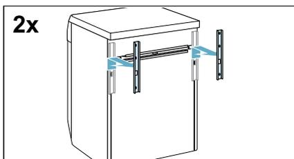
3. Desaperte e remova todos os parafusos no suporte para transporte horizontal.
