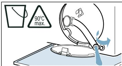
4. Desaparafuse cuidadosamente a cobertura da bomba; poderá sair água residual. Limpe o interior, a rosca da cobertura da bomba e o respetivo alojamento. O impulsor na bomba de escoamento tem de ser capaz de girar.
