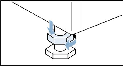
2. Ausrichtung des Geräts mit Wasserwaage überprüfen, evtl. korrigieren. Höhe durch Drehen des Gerätefußes verändern. Alle vier Gerätefüße müssen fest auf dem Boden stehen.
