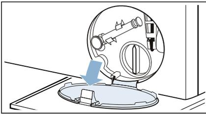
3. Entleerungsschlauch aus der Halterung nehmen. Verschlusskappe abziehen, Lauge in geeignetes Gefäß abfließen lassen. Verschlusskappe aufdrücken und Entleerungsschlauch in die Halterung einsetzen.
