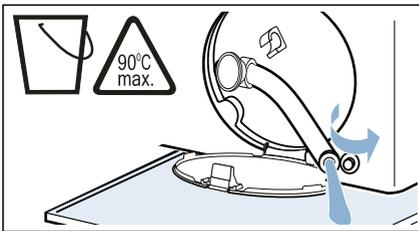
4. Pumpendeckel vorsichtig abschrauben, Restwasser kann auslaufen. Innenraum, Gewinde des Pumpendeckels und Pumpengehäuse reinigen. Das Flügelrad der Laugenpumpe muss sich drehen lassen.
