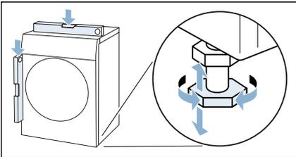
3. Kontermutter gegen das Gehäuse festziehen. Den Fuß dabei festhalten und in der Höhe nicht verstellen. Die Kontermuttern aller vier Gerätefüße müssen fest gegen das Gehäuse geschraubt sein!
