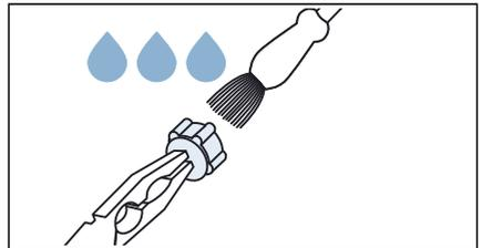
4. Schlauch anschließen und auf Dichtigkeit prüfen.
