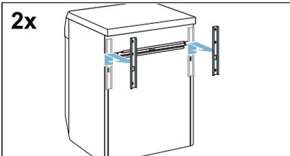
3. Die Schrauben der horizontalen Transportstrebe heraus-schrauben und entfernen.
