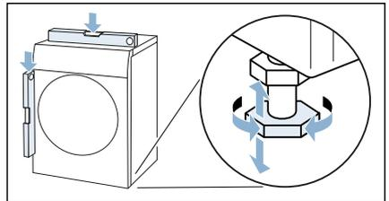
3. Kontermutter gegen das Gehäuse festziehen. Den Fuß dabei festhalten und in der Höhe nicht verstellen. Die Kontermutter aller vier Gerätefüße müssen fest gegen das Gehäuse geschraubt sein!
