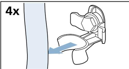
2. Alle 4 Transportsicherungsschrauben lösen und entfernen.
