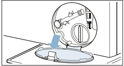
3. Am Ablaufschlauch befindet sich ein Saugnapf; den Saugnapf vom Ablaufschlauch abnehmen.
