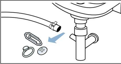
4. Ablaufschlauch wieder aufstecken und Anschluss-Stelle mit Schlauchschelle sichern.
