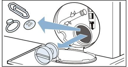
5. Pumpendeckel wieder einsetzen und verschrauben. Griff muss senkrecht stehen.
