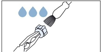
4. Schlauch anschließen und auf Dichtigkeit prüfen.
