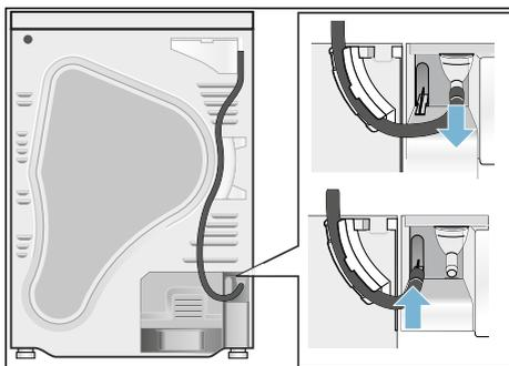
4. Retirez le flexible d'écoulement des accessoires et fixez-le sur le manchon libre.
