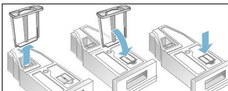
9. Insérez le réservoir d'eau de condensation jusqu'à ce qu'il s'encliquette.
