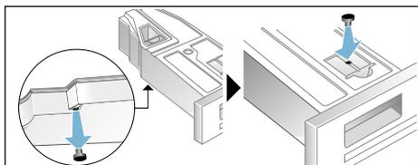
8. Retirez le filtre du crantage et placez-le dans la cavité du réservoir d'eau de condensation.
