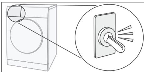
La condensation est pompée dans le réservoir à condensat à l'aide d'une pompe. Cela génère un bruit de pompage.
