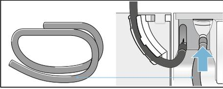
5. Fixez l'autre extrémité du flexible d'écoulement avec les accessoires restants en fonction du type de branchement A, B ou C.
