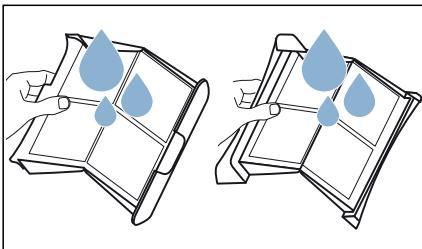
8. Flusensiebe abtrocknen, zuklappen und wieder einsetzen.
