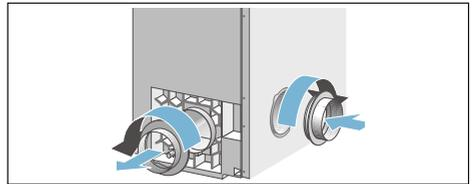
3. Die Öffnung in der Rückwand mit der Abdeckung verschließen.
