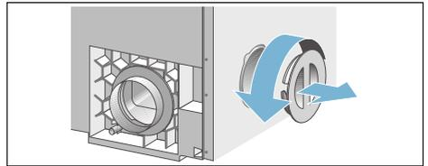
2. Den Bajonett-ring von der Rückwand entfernen und an der Öffnung auf der Seitenwand anbringen.
