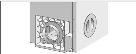
Die Abluftöffnung in der Rückwand ist im Lieferzustand des Trockners offen (Bajonett-ring). Die Abluftöffnung in der linken Seitenwand ist mit einer Abdeckung verschlossen.
