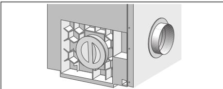
Sie können den Anschluss auf der Rückwand wie folgt zur linken Seitenwand verlegen:
